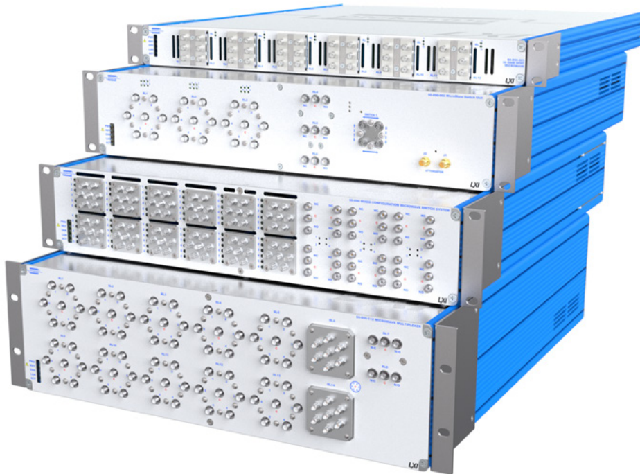
그림 3 – LXI 폼 팩터는 더 많은 페이로드를 수용하고 공간을 더 효과적으로 사용할 수 있습니다. 예를 들어, 밑에서 두번째 박스는 12개의 SP6T 및 12개의 SPDT RF 릴레이를 갖추고 있습니다.
